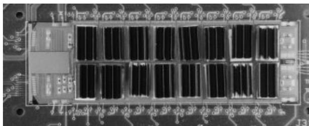
Figure 4. A pixel module
